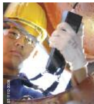
Dräger X-am 5000 Bomba de aspiración automática externa para medidas a distancia.
