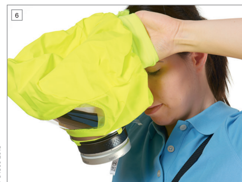
Abra la capucha por el cuello y colóquesela en la cabeza. El arnés interior se ajusta automáticamente a la cabeza. Asegúrese de que la nariz y la barbilla están dentro de la semimáscara de forma correcta y que todo el pelo queda por dentro de la capucha.
