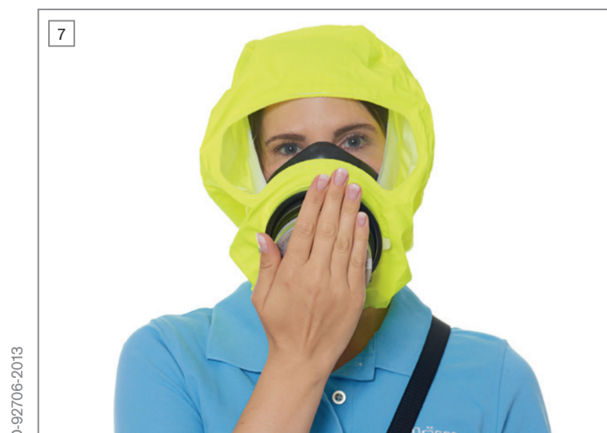
Compruebe el correcto ajuste de la semimáscara cerrando el filtro frontal con la palma de la mano. Si no se genera presión negativa, recolóque la semimáscara para asegurarse de que se ajusta perfectamente sobre la nariz y la boca.
